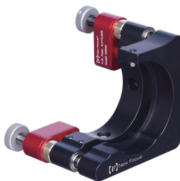
Obrázek 2.2. Umístění motorů ve stojanu—v oblouku je zasazeno zrcadlo, vpravo dole je osa otáčení, vlevo dole je horizontální motor, nahoře je vertikální motor. Obrázek je převzatý z 1 .
